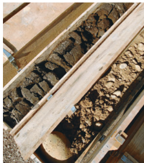
Sondierbohrungen liefern wichtige geologische Informationen. (Bild Guy Perrenoud)
